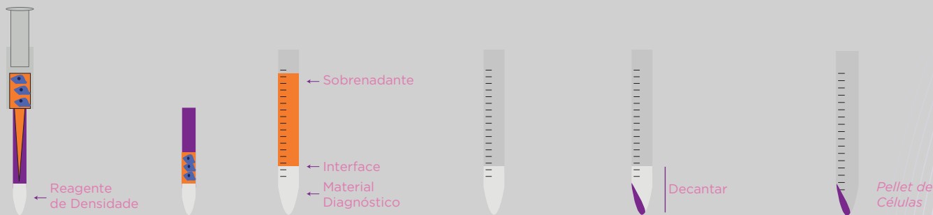
Figura 4 - BD Prepmate (SurePath): Enriquecimento celular: Primeira centrifugação da amostra junto ao reagente, aspiração do sobrenadante, segunda centrifugação do material e decantação para seleção do material enriquecido: pellet celular.
